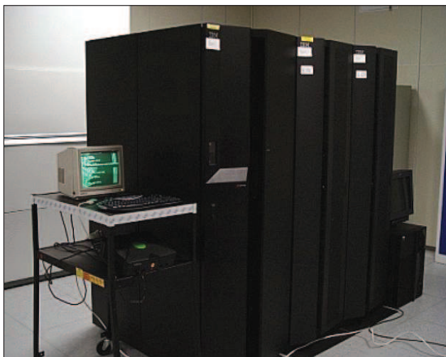
5. kép Egy német adatközpont egy Xbox alapú Domino Servert használ, ami egy IBM pSeries géppel fűrtözve fut. Az Xbox a bal oldalon látható kis doboz
