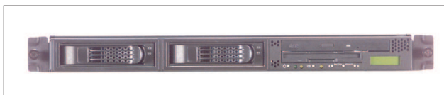
4. kép A kiszolgáló felügyeleti processzora saját LCD-vel bír, ami a CD-ROM-meghajtó alatt található
