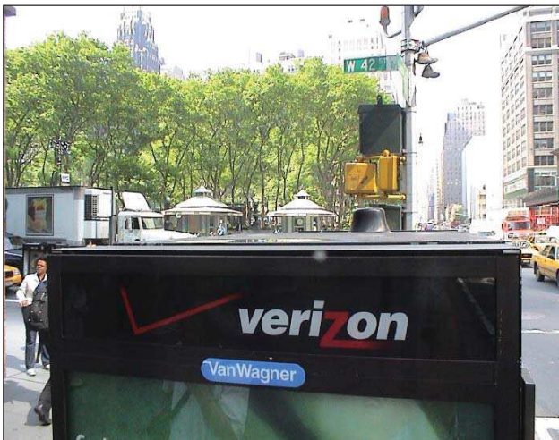
6. kép A fekete dudor ezen a nyilvános telefonon egy Wi-Fi-antenna
