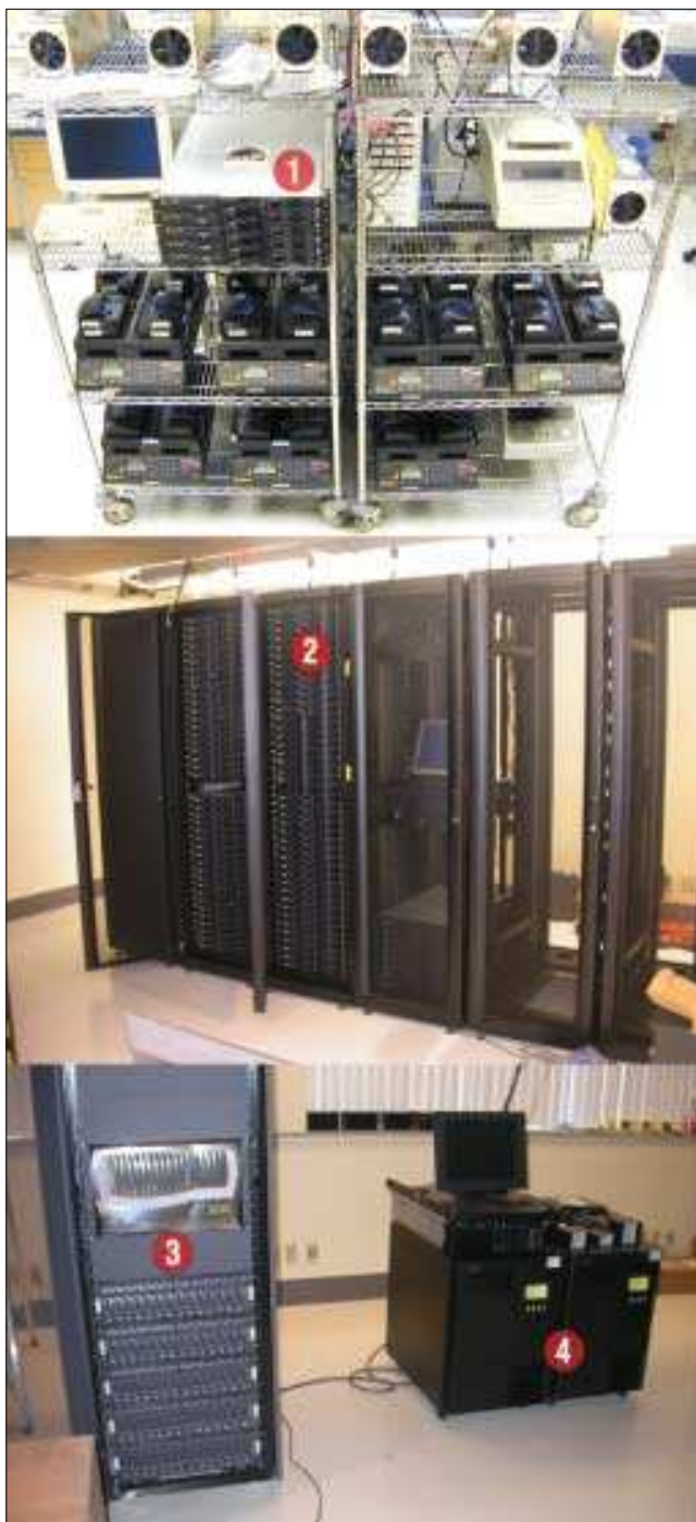
7. kép Számítási és tárolási háttér: 1. A kezdő lépések 2001 januárjában az x330 kiépítésében, 2. 84 darab x330-as csomópontot és 3. NetApp FAS960 filer és két IBM 3583 LTO egy x342-esen futó Veritasszal felügyelve és irányítva
