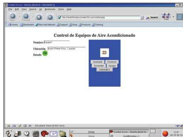
1. ábra A vezérlőfelületről a hitelesített felhasználó beindíthatja a légkondicionálót, új hőmérsékletet állíthat be vagy kikapcsolhatja azt
