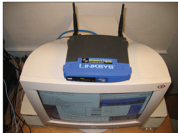
1. kép A 100 dollár alatti áron elérhető Linksys WRT54G a 16 MB memóriájával és 125 MHz-es processzorával egy alkalmas Linux-platform, amely támogatja a 802.11b és g protokollokat.
