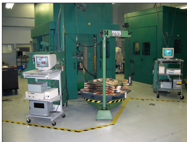
1. ábra Két SmartPress gyártási automatizáló rendszer használat közben. Minden rendszer egy PC-ből, egy DAQ-kártyából, elektronikus leválasztó rendszerből, tartalék akkumulátorból és vonalkód-nyomtatóból áll.
