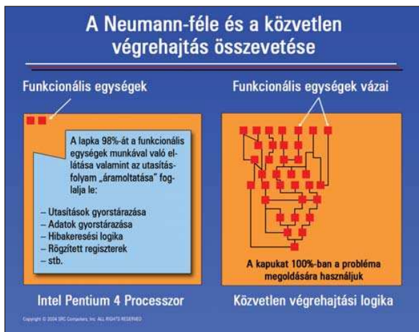
1. ábra A közvetlen futtatású logika (DEL) minden logikai kaput a valódi probléma megoldására mozgósít
