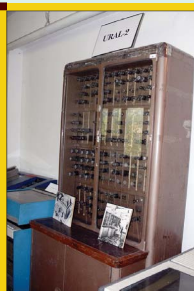
■ 4. ábra Az URAL-2-es egyik modulja (a kétezer csőből, itt csupán 200 van)
