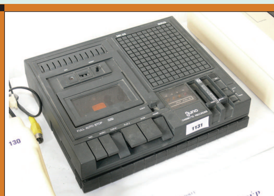
6. ábra BRG magnetofon, a Videoton TV Computer jellemző szalagos egysége
