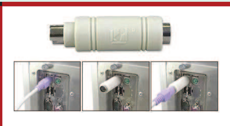
■ 9. ábra Egy 70 dolláros billentyűleütés figyelő (keylogger). Akár félmillió leütést is tárolhat.
