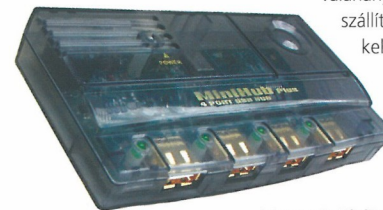
A logear's MiniHub Plus négy további USB portot biztosít a laptopnak
