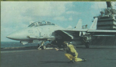
Egy F-14 Tomcat repülőgép az USS Enterprise felhártonban. A gép az AIM-54A Phoenix nagy hatóvávolságú légiharckrakkétákkal rendelkezik. A fegyverzetet a fegyvervezérlő AWG-9 rendszer irányítja.
