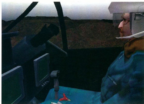
A virtuális pilótafülke nemcsak az összes műszert és képernyőt tartalmazza, hanem még a másod- lata is teljes 3D-ben jelen van. A Ka-52 pilótafülkéje szokatlan, mert a két pilóta egymás mellett ül.
