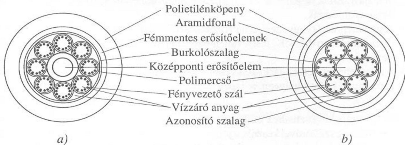
3.5.10. ábra. Sokszálas optikai kábelek szerkezete (Pirelli)
