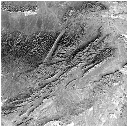
16.19. ábra. A histogram kiegyenlítéssel megnövelt kontrasztú kép. Az ábra színes változata az 813. oldalon látható.
