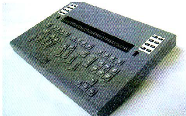
Braille-írást [brájl] használó billentyűzet és kijelző látássérültek részére. Az eszköz a képernyőn lévő adatokat Braille-írással jeleníti meg a felső részen lévő csíkon .
