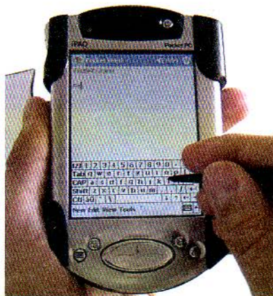
A PDA érintőképernyője egyszerre beviteli eszköz is.
