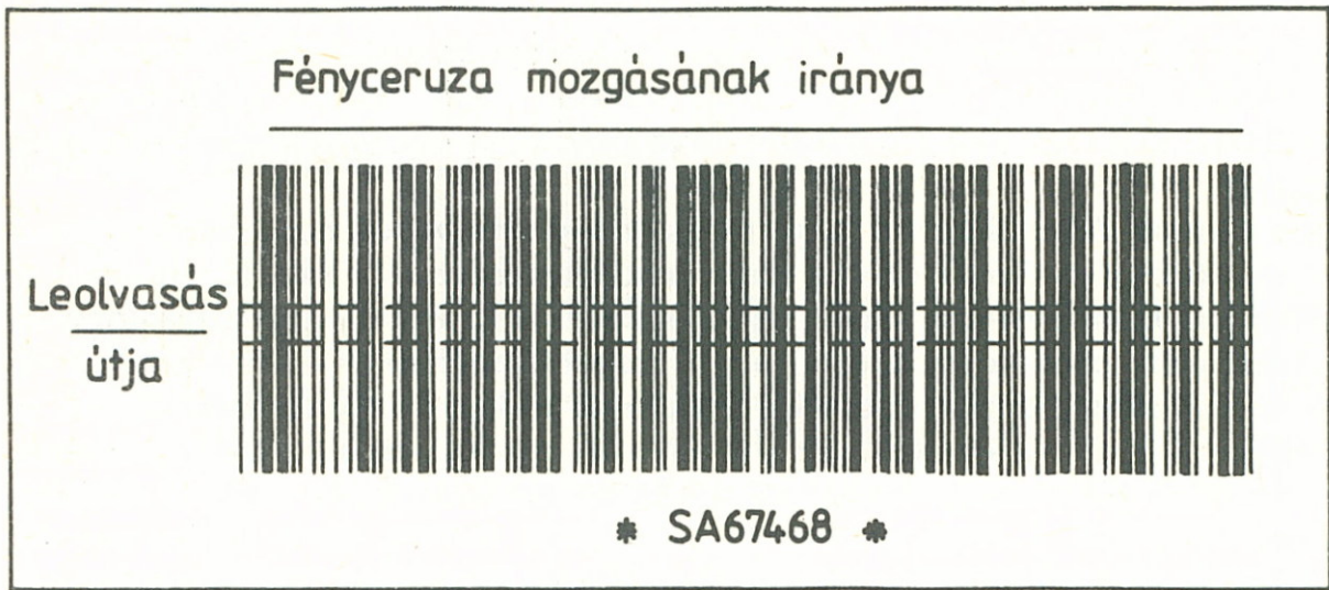
13-8. ábra A fényceruza a vonalkódnak csak egy keskeny keresztmetszetét olvassa le
