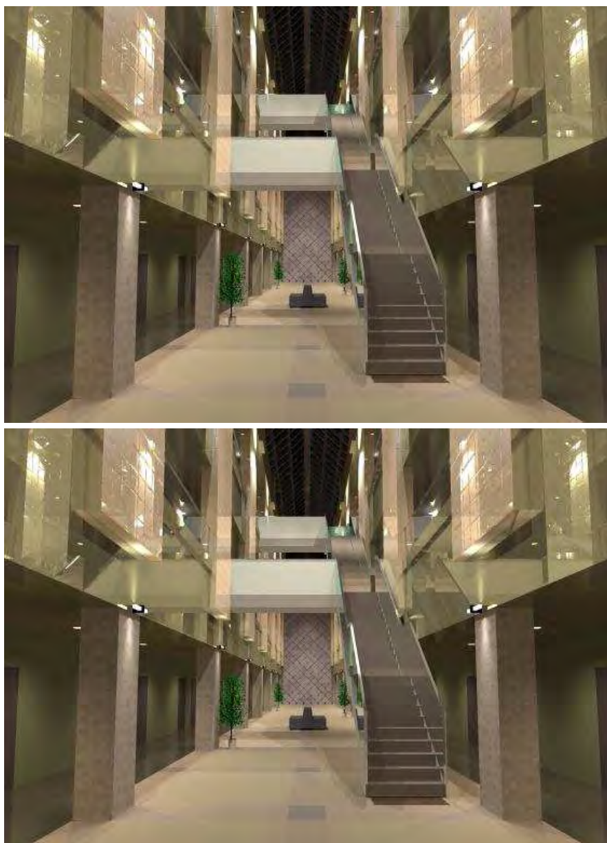
17.19. ábra. Fotorealisztikus képszintézis és a valóság összevetése. A felső kép az Aizu Egyetem előcsarnokáról készült fénykép, az alsó az előcsarnok modelljének Monte-Carlo sugárkövetéssel számított szintetikus képe (University of Aizu).
