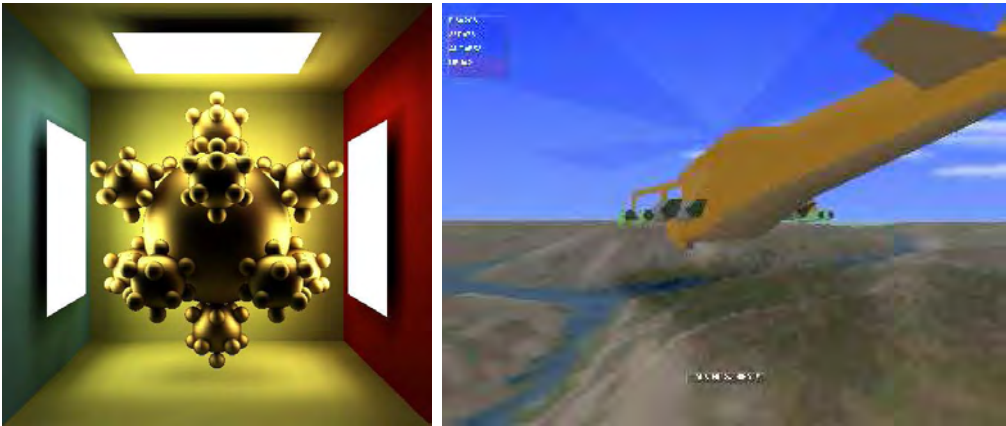
1.4. ábra. 3D világok fényképei: Bal: a fény fizikailag pontos szimulációja [SK98b]; Jobb: Egyszerűsített árnyalási modellel dolgozó valósidejű helikopter szimulátor [Dor97]
