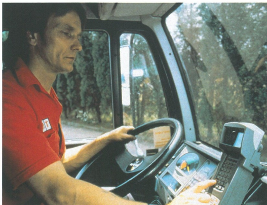
A tehergépkocsi és a fuvarozási központ közötti rádiós összeköttetés – például RAM Mobile Data készülékkel – lehetővé teszi a menet közbeni utolérést, ami érezhetően javítja a szállítási jöveldelmezőségét és biztonságát.
