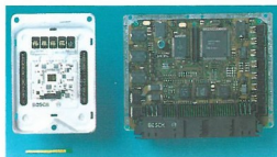
A képen a Mercedes gépkocsi ME7 típusú Bosch Motronic (bal oldalon) motorvezérlő rendszere látható. A miniatürizálás eredményeként a készülék rendkívül kis helyet foglal el.
