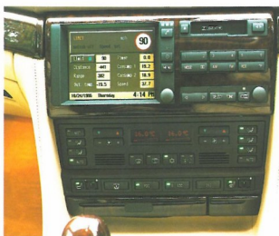
A BMW750i fedélzeti számítógépe mindenre figyel. Jelzi az esleleges meghibásodásokat, de vezérli a légkondicionálót, a rádiót, vagy a mobiltelefon is.
