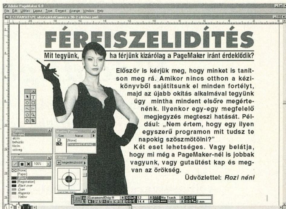
A PhotoShop-ból importált TIFF file maszkja (Clipping Path) is megmarad. (Megfigyelhető ahogy a fotó szabálytalan alakzatban takarja ki a főcímet.)
