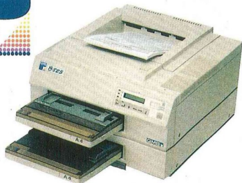
QMS-PS 825: gyors első oldal, automata interface- és emulációkapcsolás (SIO/ESP)
