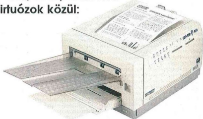
QMS-PS 410: automata emuláció-kapcsolóval rendelkezik (ESP/SIO)
