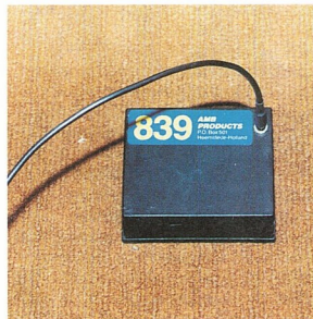
Részdíók is mérhetők a versenyautókba épített jeladók segítségével
