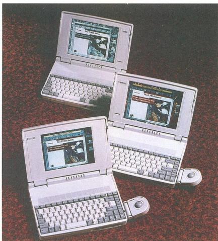
A T1950-es sorozat tagjai az Intel 40 megahertzes SL Enhanced DX2 processzorára épülnek, amely egyesíti magában az energiatakarékos SL és az órajelkettőző DX2-es lapkák előnyeit
