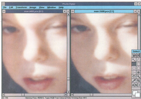
2. ábra. Már látszanak a képpontok a 400 dpi-s bal oldali ábrán, míg a jobb oldali, 1600 dpi-s kép még mindig tökéletes
