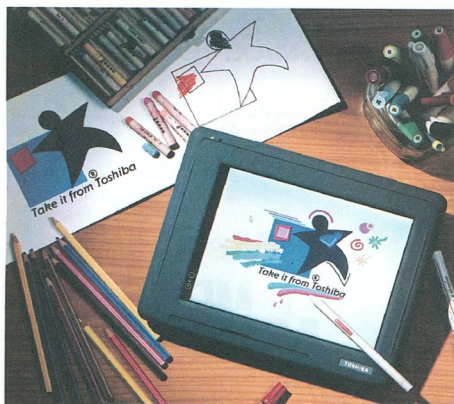
Az első színes tollalapú PC, a T200CS belsejében 40 megahertzes DX2-es lapka és 80 megabájtos merevlemez-meghajtó található
