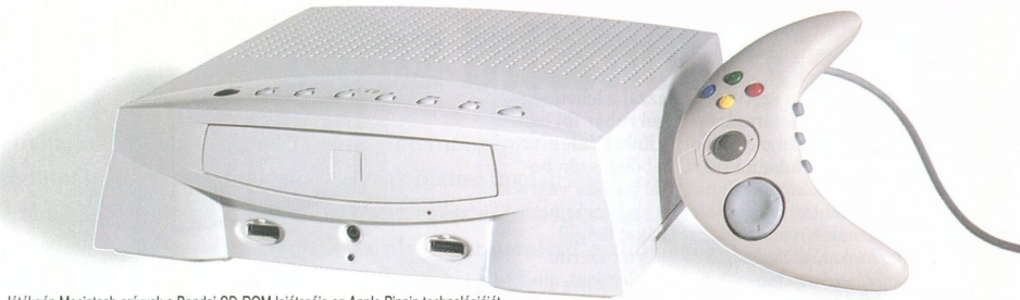
Játékgép Macintosh-szívvél: a Bandai CD-ROM-lejátszója az Apple Pippin technológiáját használja, és Internet-PC-ként is működik. A hatszáz dolláros eszköz a televíziókra csatlakozik
