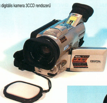
A Panasonic digitális kamera 3CCD rendszerű
