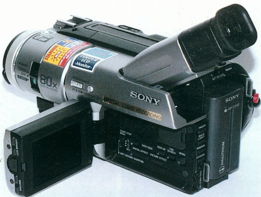
A Sony Hi8-as kazettával üzemel, és lejátszza a régi Video8-as és Hi8-as felvételeinket
