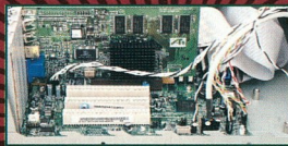
Nagy a zsúfoltság belül, a kábelkötég miatt nagyméretű kártyákkal nem használható ki mindhárom PCI rés
