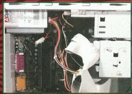
Viszonylag nagy helyet foglal a Slot 1-es hűtője, az összeszerelők nem látták szükségesnek a kábelek rögzítését
