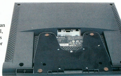
A behajtott talpra szerelhető a fali rögzítő, a csatlakozások nem zavarnak
