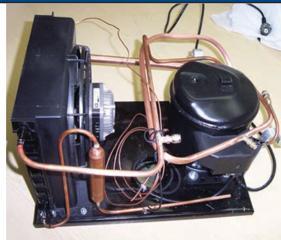
Kompresszoros folyadékűtő, ha nulla fok alatti hűtőfolyadékra lenne szükség
