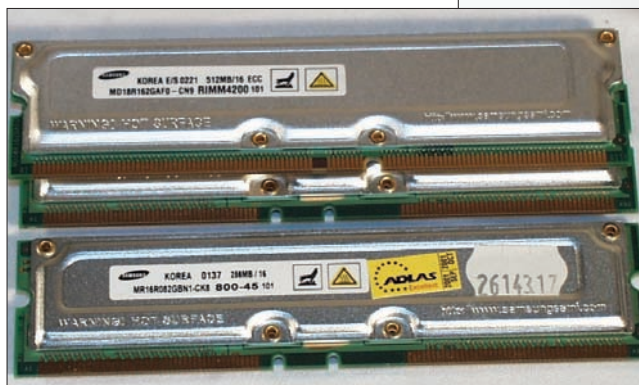
Felül a RIMM4200-as modul, alatta és előtte egy-egy PC800-as. Jól látszik a lábak eltérő száma
