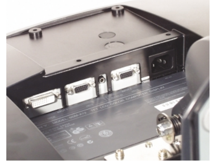
Három képbemenetet is kínál a Sony SDM-X72
