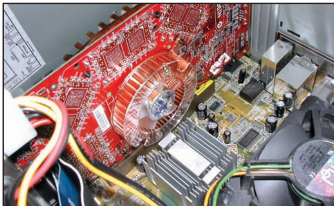
A gyakorlatban tanácsos ellenőrizni, hogy a hátsó ventilátor és a lapkakészlethűtő ellér-e egymástól
