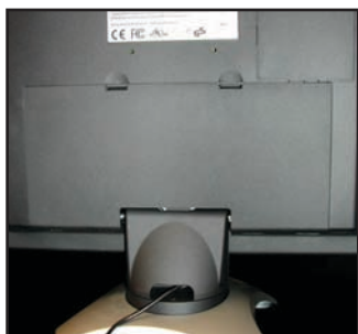
Tökéletesen eltüntethetők a kábelek a kipattintható hátlapban és az állványban
