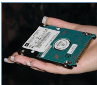
A fedél alatt két korong pörög, négy fej olvas
