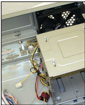
A merevlemezek rögzítőkerete és mögötte a hőérzékelős ventilátor
