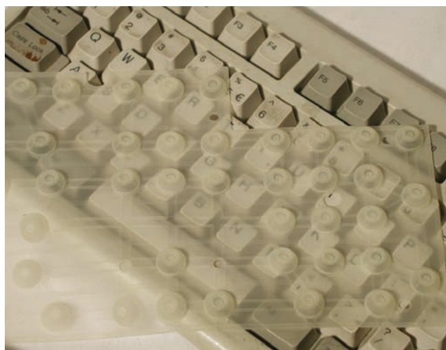
A gombok és a mátrix között vékony hátrtyaként feszül a kopásgátló gumitappancs
