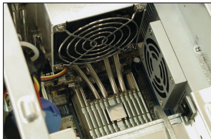
A négy hőelvezető csővel ellátott ICE-hűtés nagyon hatékony, és még viszonylag halk is
