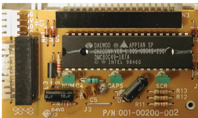
A billentyűzet lelke, a processzor olvassa a mátrix jeleit, és továbbítja a kódot a számítógépnek
