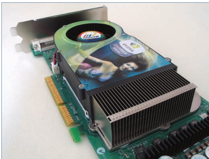
A tápellátó sorra is passzív hűtés került
