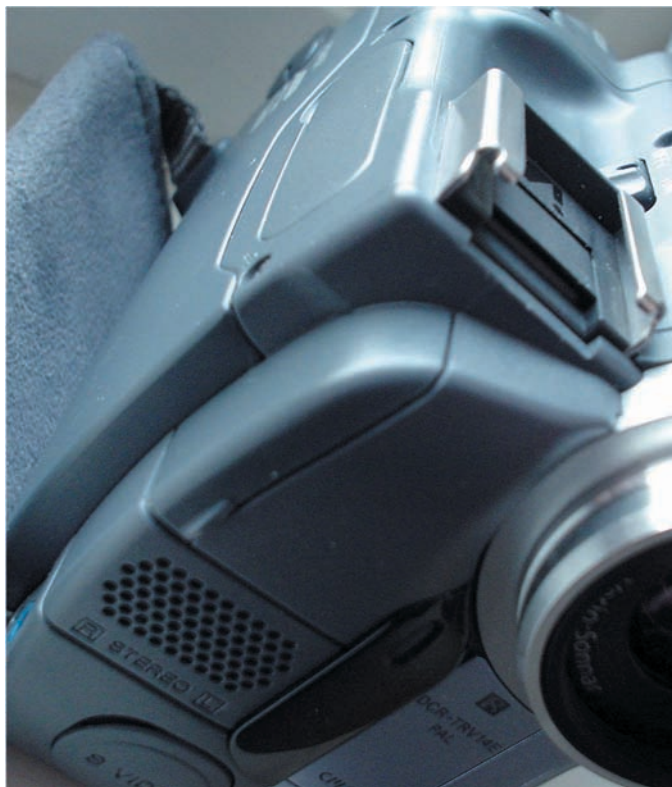
Egyes videokamerákon intelligens tartozékaljak találhatók, amelyek a zoom állása alapján szabályozzák a mikrofon érzékenységet
