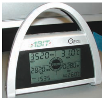
Az Abit USB-s \mu Guru órája minden fontos információt elárul a PC működéséről
