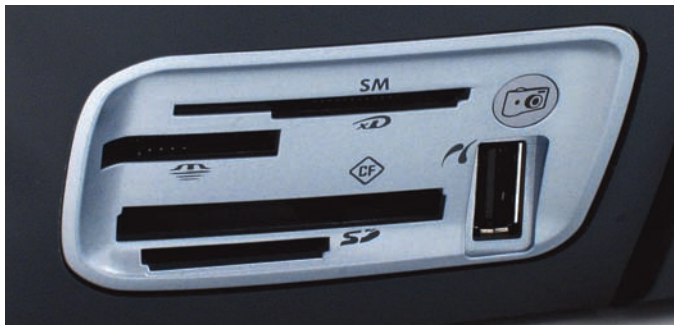
A legtöbb memóriakártyát fogadja a HP készüléke, sőt egyes digitális kamerákat is közvetlenül csatlakoztathatunk rá
