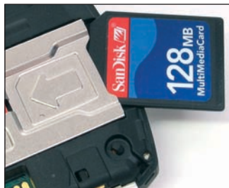
Kikapcsolás nélkül, de csak a hátlap levétele után cserélhető a memóriakártya
