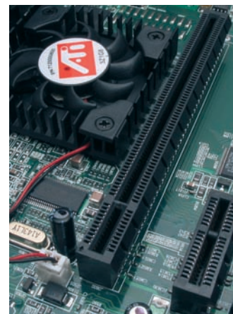
Az integrált mellett erősebb VGA-kártyát is használhatunk a PCI Express x16-os foglalatban
