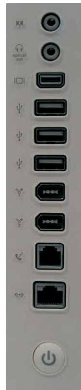
A csatlakozók és a bekapcsológomb a hátoldalon
