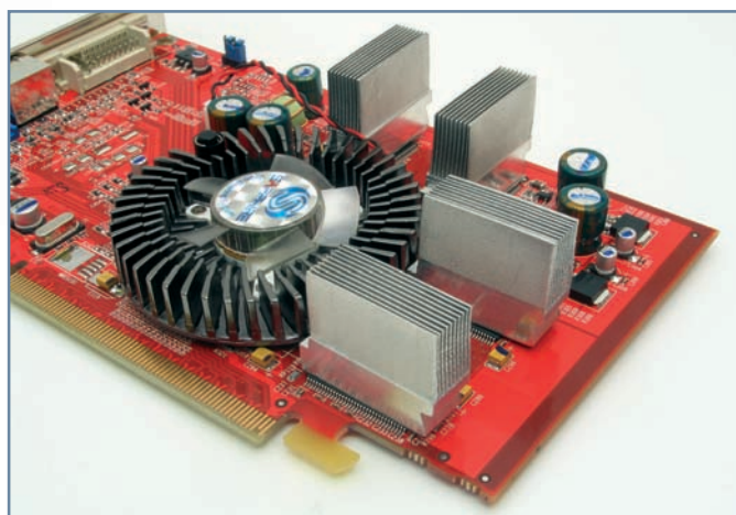
A videokártya memóriaplakáit is érdemes hűtenünk nagyobb igénybevétel esetén
