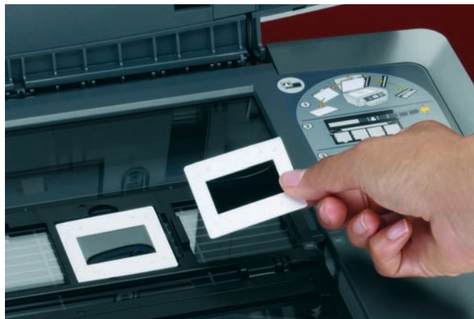
Két készülékben is találkoztunk filmadapterrel, segítségével akár közvetlenül készíthetünk nagyítást negatívjainkról, diáinkról
