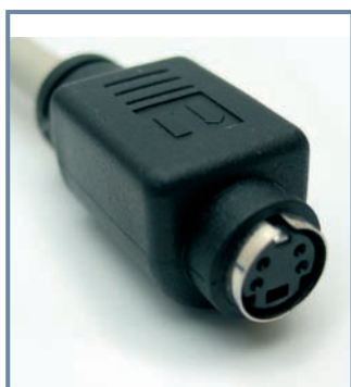
Külön vezetéken utazik a szín- és a fényességinformáció az S-Video kábelek esetében, ezért DVD-minőségű kép átvitelére is alkalmazhatók
