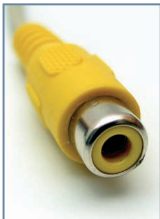
Általában egyszerű RCA-dugó formájában végződik az egyeres, szerény átviteli minőséget biztosító kompozit videokábel
