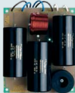
Minőségi keresztváltó egység, a képen egy Bowers & Wilkins hangfalból
