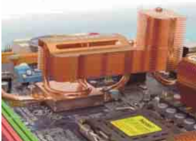
Furcsa, de hatékony megoldás a torony kialakítású hűtőrendszer
