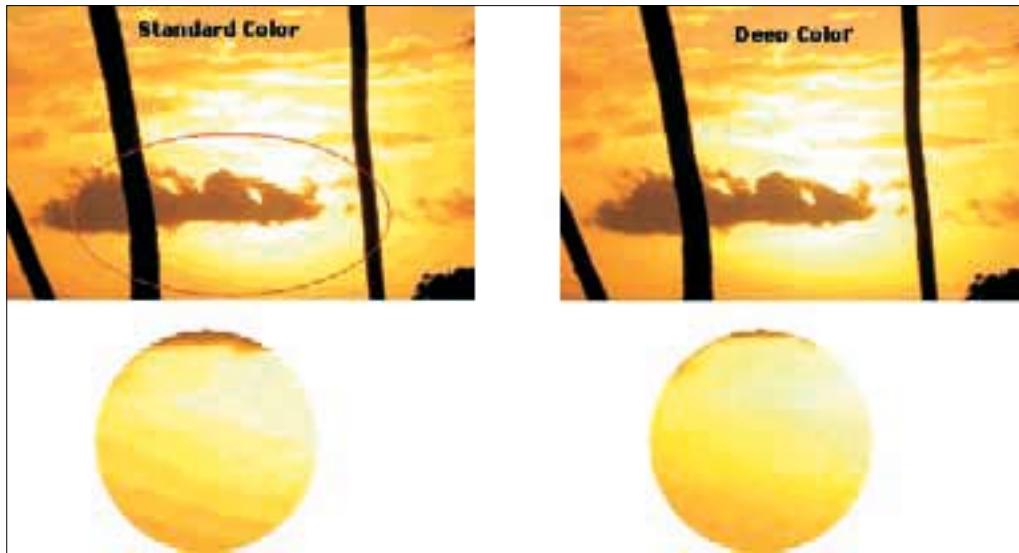
A pirossal jelzett részen jól látható a koncentrikus körökben lépcsőzetes színátmenet – a jobb oldali kép a HDMI 1.3 szinkódolásával elérhető eredményt mutatja
