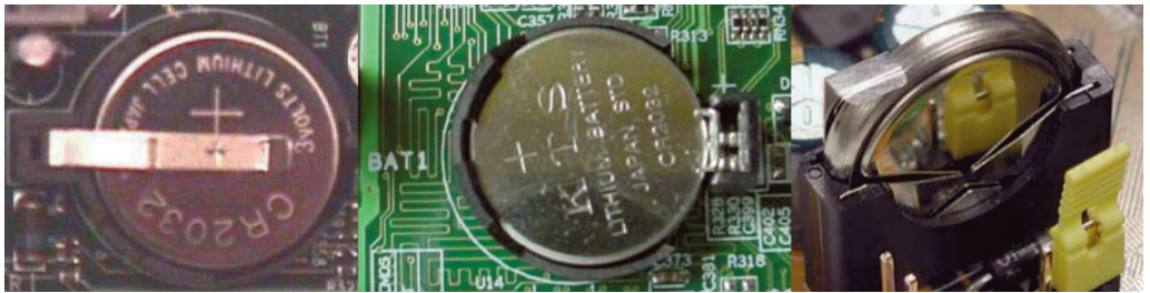
Különböző típusú elemfoglalatok, amelyek előfordulhatnak az alaplapon – az elem segítségével őrzi meg a BIOS beállításait a gép kikapcsolt állapota közben is
