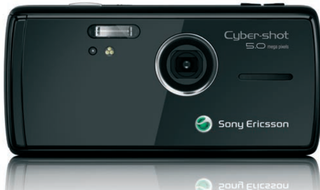
Az 5 megapixeles kamerát Xenon vaku és autofókusz segédfény támogatja
