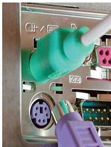
Bár a két PS/2 aljzat egyformának tűnik, nem véletlenül vannak külön színnel jelölve – felül (zöld szín) az egér, alul (lila szín) a billentyűzet aljzata
