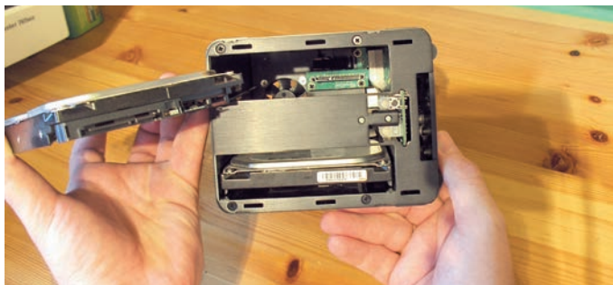
A SATA-merevlemez behelyezése pofonegyszerű. Félmagas meghajtók esetén fordítsuk bal oldalára a készüléket, hogy elkerüljük a koccanást.
