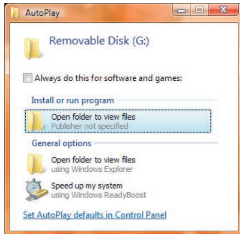
A Confickerrel fertőzött USB-kulcs a Windows saját beállítóablakát indítja el, igaz, kissé megpatkolva: az első sor ugyanis a vírust indítja, holott úgy látszik, mintha csak az eszköz gyökérmappájába lépnénk be vele
