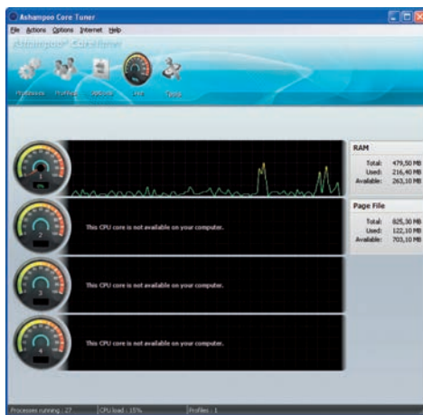
Tesztgépünkben csak egymagos processzor volt, de a program akár négy mag figyelését is elvégzi
