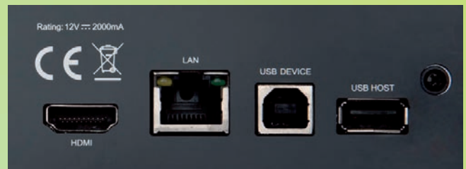
Jobb szélén a külső merevlemezek csatlakoztatásához kialakított USB A aljzat található, tőle balra az USB B. Számítógéphez kötve rendszerint ezzel használhatjuk magát a lejátszót merevlemezként
