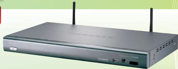
Jobb szélén a külső merevlemezek csatlakoztatásához kialakított USB A aljzat található, tőle balra az USB B. Számítógéphez kötve rendszerint ezzel használhatjuk magát a lejátszót merevlemezként
