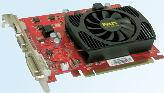
Az NVIDIA GeForce GT 220 grafikus vezérlő mellé semmi esetre se vásároljunk felső kategóriás processzort, mert még alacsony felbontáson is hamar VGA limitbe ütközhetünk
