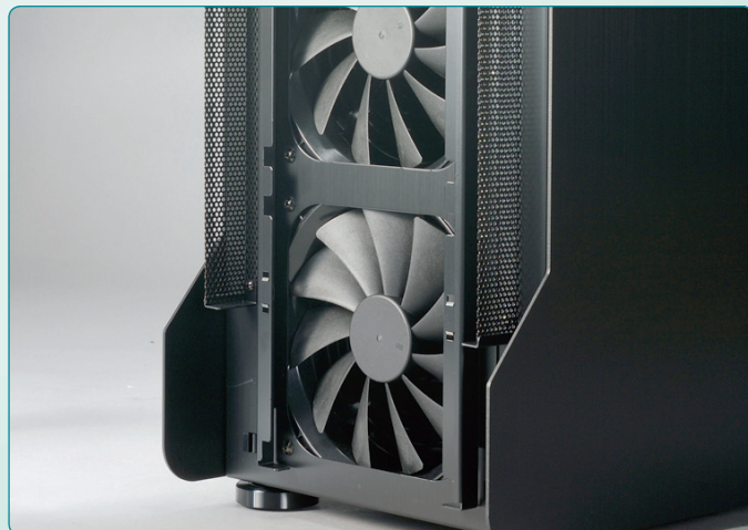
Kritikus pont a ház szellőzése. A több és lassabban forgó ventilátor jelenti az optimális megoldást zaj és hűtés tekintetében, de ne essünk túlzásokba!
