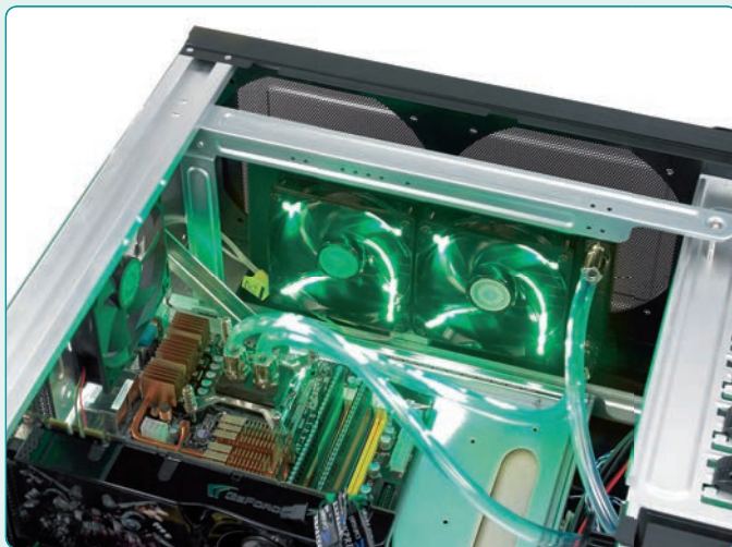
Az egyik leghalkabb megoldás, ha vízhűtést használunk passzív VGA- és lapkakészlethűtés mellett
