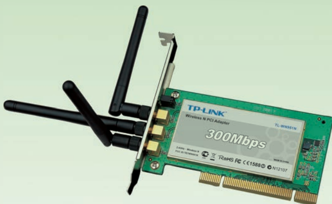
Három antennájának köszönhetően a PCI-foglalatba illeszthető WN951N igazán jó vételi teljesítménnyel dicsekedhet
