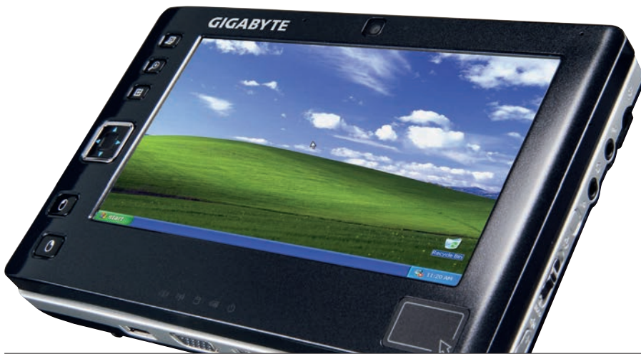
Jól láthatók a kijelző körül azok a segédgombok, melyek feltétlenül szükségesek a billentyűzet és egér nélküli használathoz
