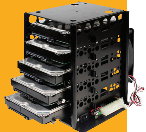
Egy beépítő keretben több merevlemez-egység. A kapacitásukat összeadhatjuk a logikai kötetkezelés segítségével
