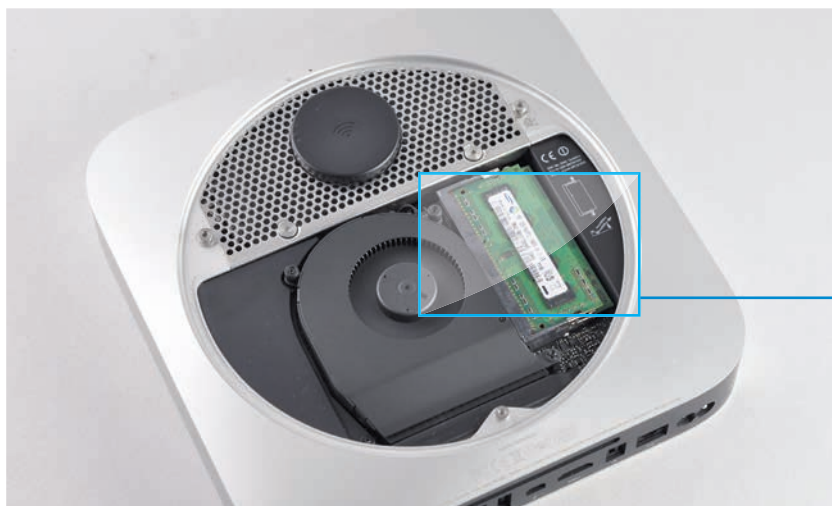
A készülék alján található takaréplemez egy mozdulattal eltávolítható, így könnyedén bővíthető a memória
